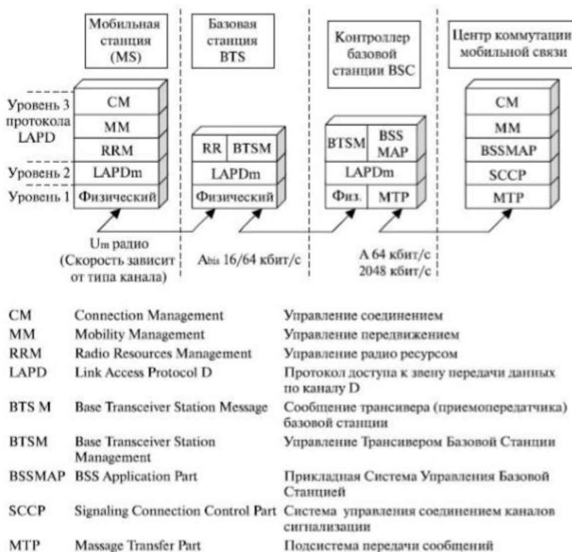
Рисунок 1.2 – Уровни сигнального протокола в GSM
