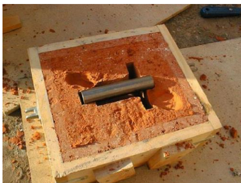
Рис.2 Фото процесса литья в песчаные формы
